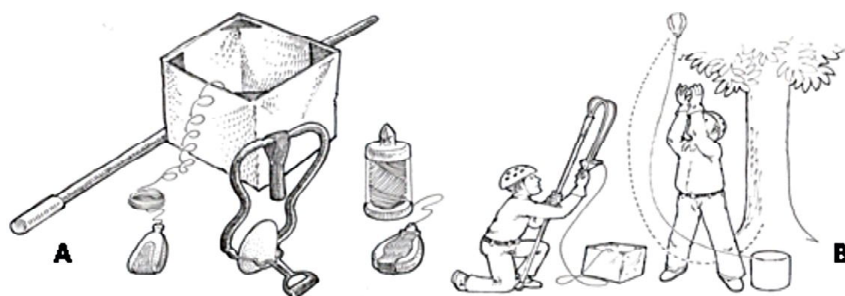
Figura 7. A , Materiales utilizados para la técnica de línea de avanzada, pesos, lienzas, lanzador, pértiga, caja para la lienza; B , Método de lanzamiento con lanzador y pértiga telescópica, y lanzamiento manual.
